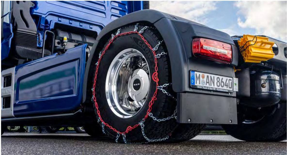
Unsere aus gehärtetem 5,5 oder 7 mm Stahl gefertigten Schneeketten für Lkw bieten unübertroffene Traktion und Stabilität auf Schnee und Eis. Dank ihrer robusten Konstruktion, der hochwertigen Materialien mit Korrosionsschutz sind sie langlebig und zuverlässig, selbst unter extremen Bedingungen.
