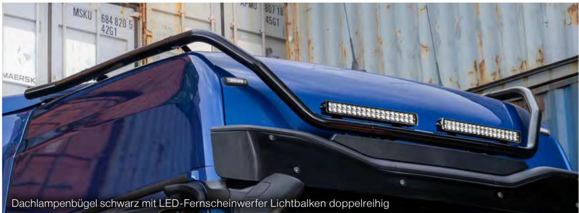
Dachlampenbügel schwarz mit LED-Fernscheinwerfer Lichtbalken doppelreihig
