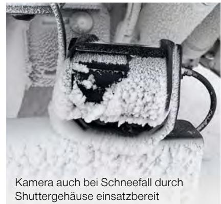
Kamera auch bei Schneefall durch Shuttergehäuse einsatzbereit
