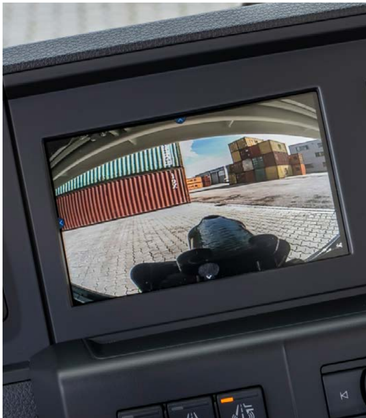
Kamera auch bei Schneefall durch Shuttergehäuse einsatzbereit
