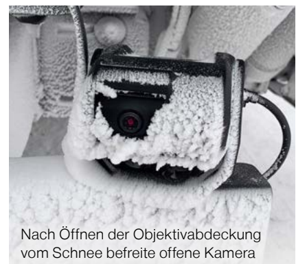
„Augenlid“-Effekt beim Öffnen der Objektivabdeckung
