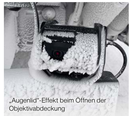
Kamera auch bei Schneefall durch Shuttergehäuse einsatzbereit
