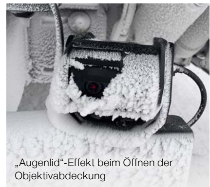
Kamera auch bei Schneefall durch Shuttergehäuse einsatzbereit
